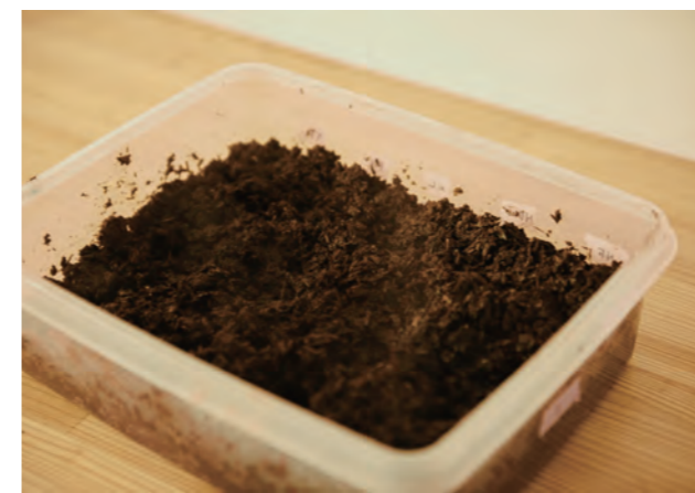
生分解性マテリアルの崩壊度を調べるためのコンポスト
