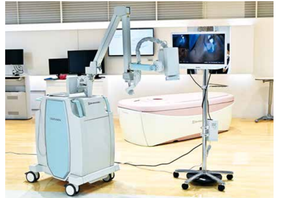
光免疫療法に応用を目指す近赤外光カメラシステム「LIGHTVISION」 血管・リンパ管等に投与した薬剤(ICG)に近赤外励起光を照射し、ICGから発生する微弱な近赤外蛍光を画像化することで、組織表面下の血管やリンパ管の観察を可能にするシステム
