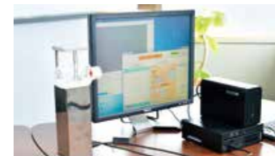
細胞観察装置。Webシステムやタイムラプスなどの機能を搭載しながらも安価で小型なのが特徴
