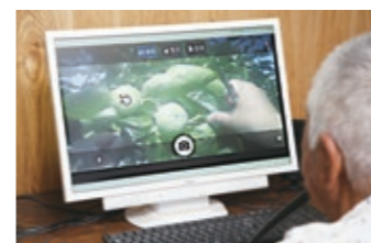
スマートグラス(エプソン BT-2000)による遠隔作業 熟練者は自宅のパソコン前に待機してマウスを操り、摘果すべき果実にカーソルを合わせて指示を送る。
