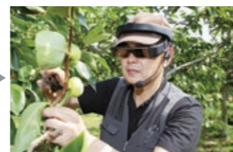
スマートグラスのディスプレイ正面に必要な作業が表示される。指示通りに果実を切り落とす。不明な点は付属のマイクで応答し確認できる。
