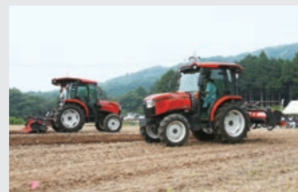
有人監視下での無人自動運転が可能なトラクタ 農業の担い手を支援する
