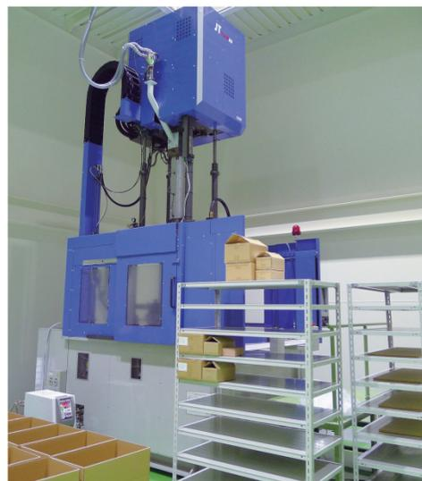
縦型電動ロータリー成型機の220トン機を導入
