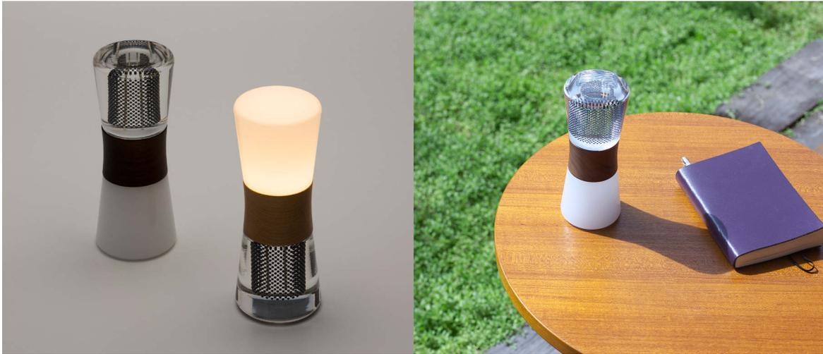
粒状の太陽電池に光があたると、砂時計の砂が落ちるように、少しずつ電気を蓄えます。夜、ランタンを上下ひっくり返すと、昼間たくわえた電気ですっきりとした光が灯ります。スフェラーランタンにはスイッチはありません。製品本体を上下ひっくり返す動きで充電 / 点灯が切り替わります。
